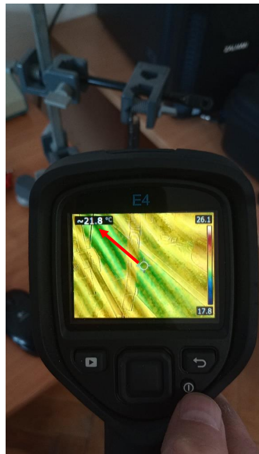
Rys. 1. a) zestaw pomiarowy, b) ekran kamery termowizyjnej, temperatura na celowniku wyświetlona w lewym górnym rogu.
